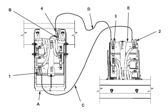
DISCONNECT JUMPER CABLES IN THE REVERSE ORDER THAT THEY WERE CONNECTED.
