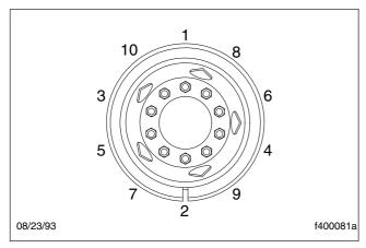
Fig. 12.10, Tightening Pattern, 10-Stud Disc Wheels
